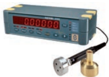
Tampon SmartPlug avec un palpeur connecté à un coffret d'affichage
